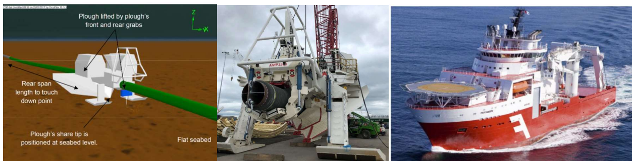
Figur 7-6: Prinsipp for mekanisk grøfting og eksempel på plog og fartøy egnet for grøfting av VRGP, ref. /27/.
