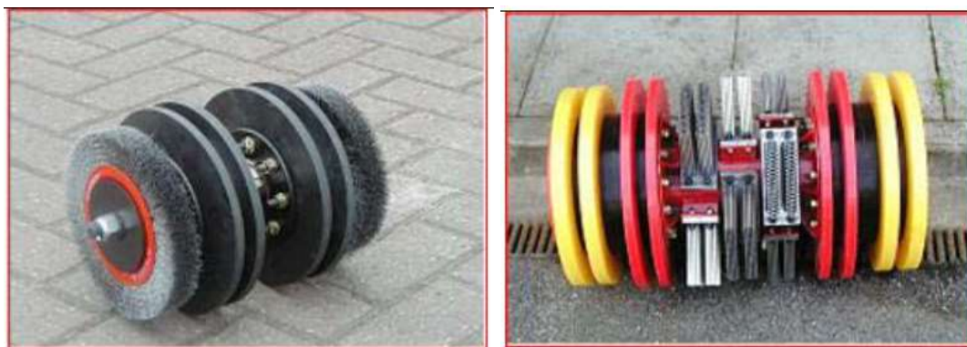
Figur 7-2. Rense- separasjonspigger utstyrt med børster for innvendig rengjøring (venstre) og magneter for å bringe med seg magnetisk materiale.
